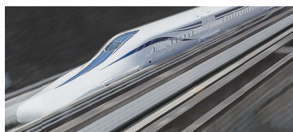
■山梨リニア実験線で走行試験中のL0(エル・ゼロ)系改良型試験車
